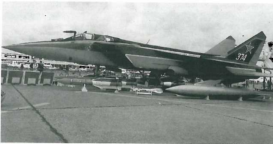
MiG-31 FOXHOUND visades i väst för första gången. MiG-31 är ett tvåsitsigt, tvåmotorigt jaktflygplan som främst är baserat i Kolaområdet. Det är avsett att försvara Sovjet mot bl.a. kryssningsrobotar. MiG-31 är beväpnat med jaktrobotar av typ AA-6 ACRID, AA-8 APHID, AA-9 AMOS och en fast sexpipig akan av Gatlingtyp. Foto: Owe Björnelund.
