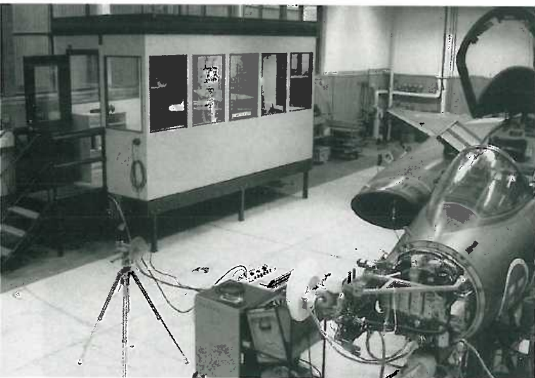
Den fasta teleteststationen på F10. För att få god ögonkontakt mellan operatörerna är som framgår av bilden den fasta upphöjd.
