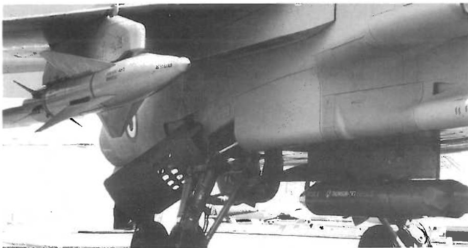
Franska Jaguar A deltog också i Gulf-kriget. Detta flygplan är beväpnat med två AS-30L, två Matra Magic 2 IR-jaktrobot. För egenskydd finns även fackelfällare och kapselhängda telemotmedel. På centralbalken hänger en Atlis II pod som används för målutpekning för AS-30L-roboten. Foto: Owe Björnelund.
