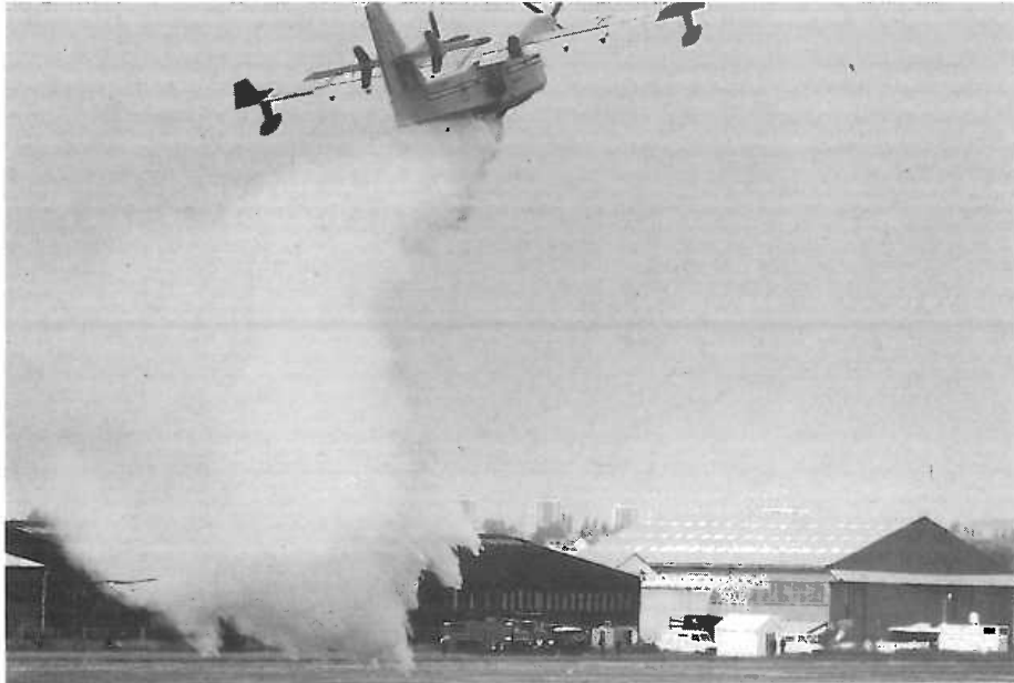
Canadair CL-215T är ett amfibieflygplan speciellt framtaget för skogsbrandbekämpning, men är också väl lämpat för kustbevakning och räddningsuppgifter. CL-215T tar 6000 liter vatten. Flygplanet har två Pratt&Whitney 123-AF turbopropmotorer på 2350 shp. Foto: Owe Björnelund.
